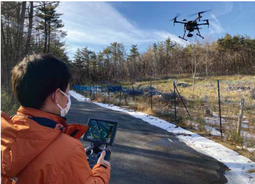
日中には飛行ルートの作成や周囲の安全性を確認し、赤外線カメラを搭載しての飛行は夜間に行う。
